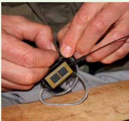
La balise se recharge grâce à de petits capteurs solaires.
